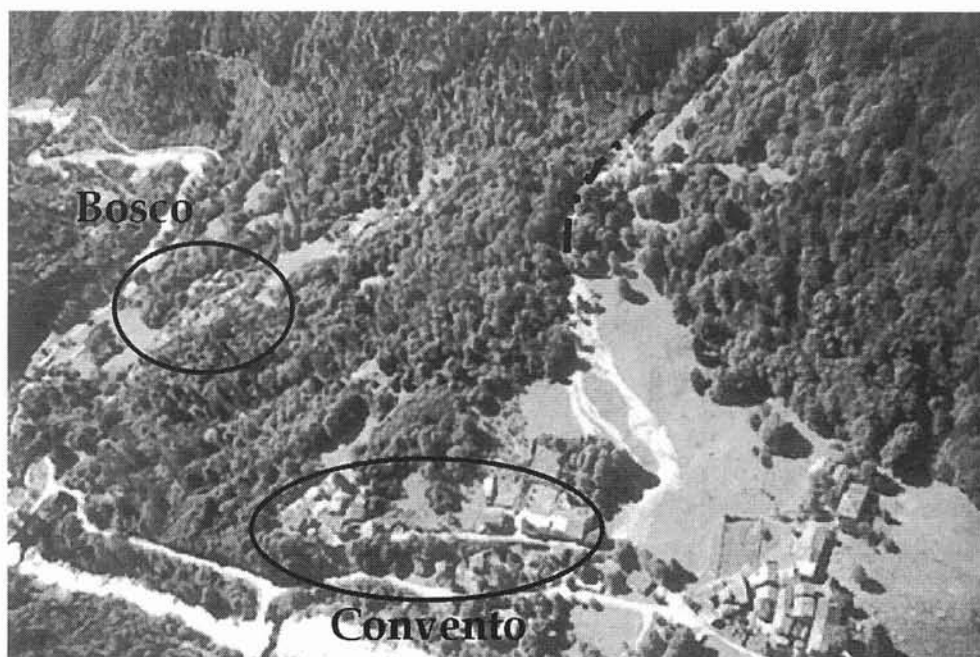
FIG. 6 - Foto aerea del conoide di Bosco dopo l'evento del 15 luglio 2001. La linea tratteggiata indica il settore apicale nel quale il flusso è fuoriuscito dall'alveo. Sul pendio erboso è possibile vedere il flusso di acqua e sedimento (Foto di Tropeano & Turconi in Lollino & alii, 2001, modificata).
